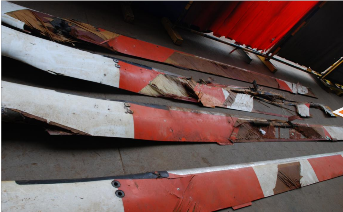
Figura 3 – Alguns Detalhes Sobre os Danos da Pá Cor de Laranja da Aeronave D2-EYI
