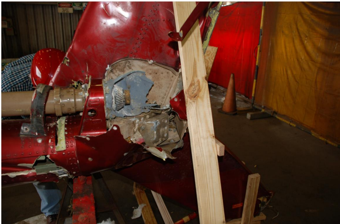
Figura 6 – Detalhes Sobre o Veio de Transmissão do Rotor Traseiro Desintegrado da Aeronave D2-EYI
